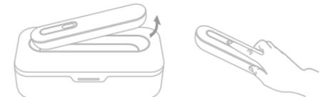
Plaats de te desinfecteren voorwerpen in de doos. Sluit het deksel. Druk nu op de ON/OFF knop. De desinfectie wordt gestart. Het automatische desinfectieprogramma loopt 6 minuten. Dit wordt aangegeven door het LCD-display boven op het deksel. Na het inschakelen van het apparaat telt het af vanaf 360. Dit betekent tot op de seconde. Na afloop van de 6 minuten wordt het apparaat automatisch uitgeschakeld.
