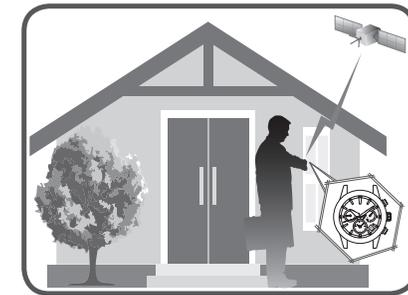
\*Im Gegensatz zu Navigationsgeräten ist diese Uhr nicht dafür ausgelegt, bei normalem Gebrauch permanent GPS-Signale von GPS-Satelliten zu empfangen. Die Uhr empfängt GPS-Signale nur im Zeitzonenanpassungsmodus und im automatischen oder manuellen Zeiteinstellungsmodus.
