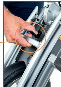
4 Kippen Sie den Stigo und ziehen Sie den Lenker hoch, bis Sie das den Mechanismus verriegelnde KLICK hören.
