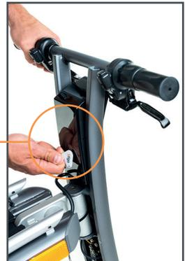
Zum Ausschalten des Stigo-Rollers drücken und halten Sie den EIN/AUS-Schalter für 2 Sekunden, bis sich das Display ausschaltet.
