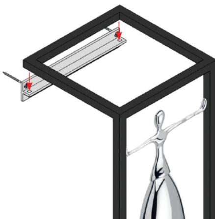
Platzieren Sie den Montagerahmen auf der Wandhalterung und richten Sie die Löcher für die Befestigungsschrauben.
