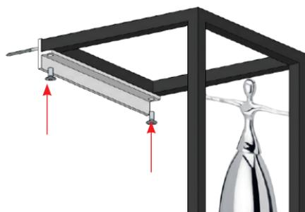
Befestigen Sie den Montagerahmen mit den mitgelieferten Schrauben an der Wandhalterung, um das Produkt zu sichern.
