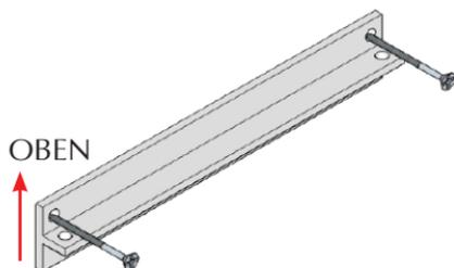
Befestigen Sie die Wandhalterung durch die vorgefertigten Löcher mit den Schrauben an der Wand. Stellen Sie sicher, dass die Wandhalterung waagrecht ist.
