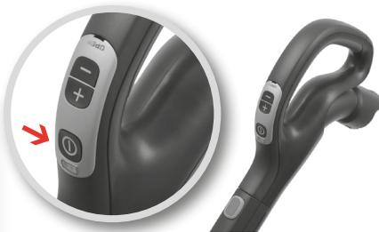
8. Modelle mit Fernbedienung können auch mit der 0/1-Taste (EIN/AUS) des Griffes bedient werden.\*
