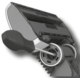
3. Die Radachse abschrauben und alle Teile reinigen. Zusammenbau in umgekehrter Reihenfolge.
