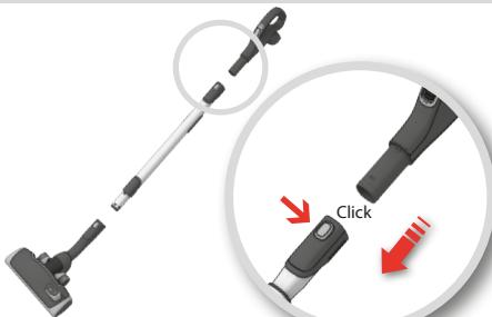
4. **Teleskoprohr auf Schlauchgriff stecken** (zum Abnehmen den Verriegelungsknopf drücken und Schlauchgriff herausziehen).
