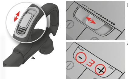
9. Saugleistung einstellen. (modellabhängig) a. Mit dem Saugleistungsregler am Griff lässt sich der Luftstrom schnell regulieren. b. Schieberegler am Staubsauger zum Einstellen der Saugleistung verwenden. c. Wippschalter + oder – am Staubsauger zum Einstellen der Saugleistung verwenden.\*
