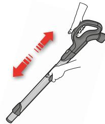
5. **Teleskoprohr anpassen**, indem Sie mit einer Hand den Verriegelungsknopf drücken und mit der anderen Hand am Griff ziehen.
