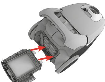
6. Nach dem Austauschen des Filters kann die **Filterabdeckung zurückgedrückt werden**, bis die beiden Knöpfe einrasten.
