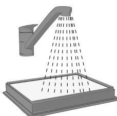
**5. Reinigen des waschbaren Abluftfilters:** Innenseite (schmutzige Seite) unter fließendem warmem Wasser ausspülen. Gegen den Filterrahmen klopfen, um das Wasser zu entfernen. Vorgang vier Mal wiederholen.
