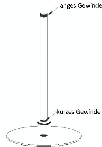
Schritt 2: Schrauben Sie die mittlere Stange an die untere Stange.
