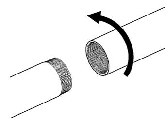
Schritt 3: Schrauben Sie die obere Stange an die mittlere Stange
