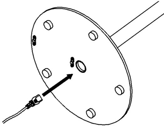
Schritt 5: Verbinden Sie das Stromkabel mit der Buchse im Kopfteil.
