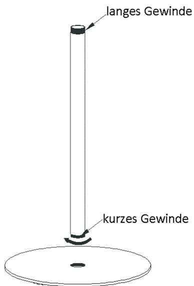
Schritt 2: Verschrauben Sie die mittlere Stange mit der unteren Stange.
