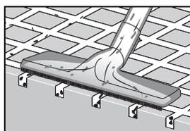
Munstycket för hårda golv passar bäst för rengöring av hårda golv med sprickor och fogar. Munstycket måste ligga an helt mot ytan, för att rengöringen av sprickor och fogar ska bli optimal. Det kan vara till hjälp att luta munstycket en aning, om man vill suga upp grov smuts.
