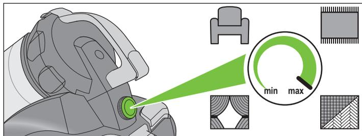
Der Leistungsregler (siehe oben) ist stufenlos verstellbar. Je nach zu saugendem Untergrund sollte die Stellung des Leistungsreglers angepasst werden:
