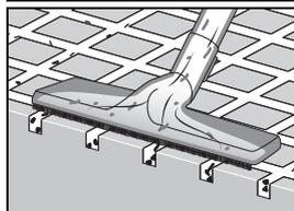
Die Hartbodendüse eignet sich bestens zur Reinigung von Hartböden mit Ritzen und Fugen. Um Ritzen und Fugen optimal zu reinigen, muss die Düse vollständig aufliegen. Um Grobschmutz aufzunehmen, kann es hilfreich sein, die Düse leicht anzukippen.
