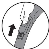
W razie przypadkowego wciągnięcia firanek, żaluzji lub innych przedmiotów należy szybko otworzyć regulator powietrza, aby uwolnić te przedmioty.
