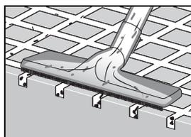
La boquilla para suelos duros es ideal para la limpieza de suelos duros con ranuras y juntas. Para limpiar ranuras y juntas de forma óptima hay que apoyar la boquilla por completo. Para atrapar la suciedad mayor puede ser útil inclinar la boquilla ligeramente.
