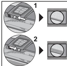
De turboborstel is ideaal voor het opnemen van dierenharen en zorgt ervoor dat de tapijtvezels weer rechtop gaan staan. *Maar let op: alleen ongevoelige oppervlakken met de turboborstel reinigen. Anders kunnen er beschadigingen ontstaan. Via de schuifregelaar kan het toerental van de roterende borstelrol worden aangepast:*
