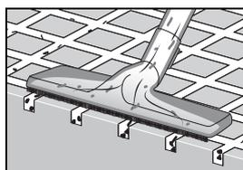
Dysza do twardych podłóg doskonale nadaje się do czyszczenia twardych podłóg ze szczelinami i fugami. Aby optymalnie wyczyścić szczeliny i fugi, dysza musi całkowicie przylegać. Przy zbieraniu zgrubnych zanieczyszczeń pomocne może być lekkie przechylenie dyszy.
