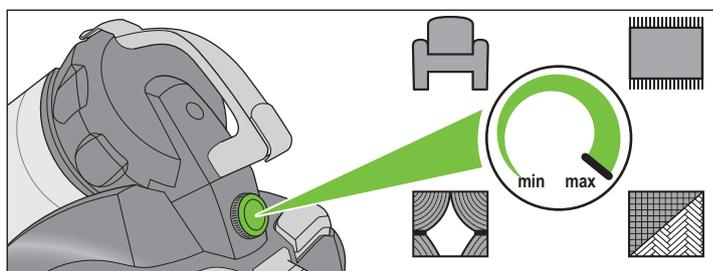
Effektreglaget är steglöst ställbart (se ovan). Anpassa inställningen av effektreglaget efter det underlag som ska dammsugas:
