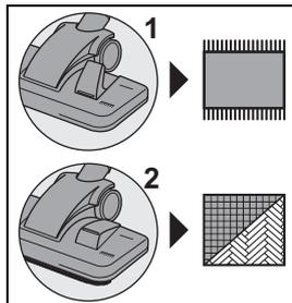
Die umschaltbare Bodendüse verfügt über 2 Einstellmöglichkeiten:
