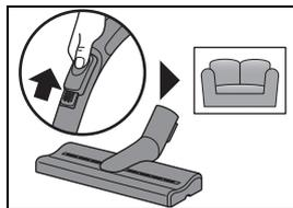
La bocchetta per imbottiti si adatta al meglio per mobili imbottiti, imbottiti e materassi. *Ma cautela: affinché la bocchetta per imbottiti non aspiri aderendo al fondo, si raccomanda di aprire leggermente (se necessario anche di più) il regolatore del flusso d'aria presente nell'impugnatura.*
