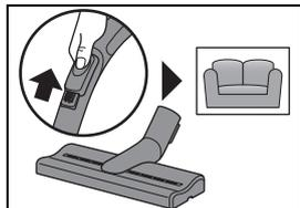
L'embout pour les coussins est très bien adapté pour les meubles capitonnés, les coussins et les matelas. *Mais attention : pour que l'embout à coussins ne reste pas collé à la surface, il est recommandé d'ouvrir légèrement (plus si nécessaire) le variateur de puissance sur la poignée.*
