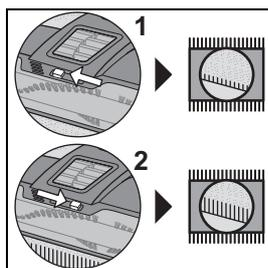
Szczotka turbo idealnie nadaje się do zbierania sierści i podnoszenia runa dywanu. *Proszę zachować ostrożność: szczotką turbo czyścić jedynie niewrażliwe powierzchnie. W przeciwnym przypadku może dojść do uszkodzenia.* Regulatorem przesuwającym można zmieniać prędkość obrotową szczotki:
