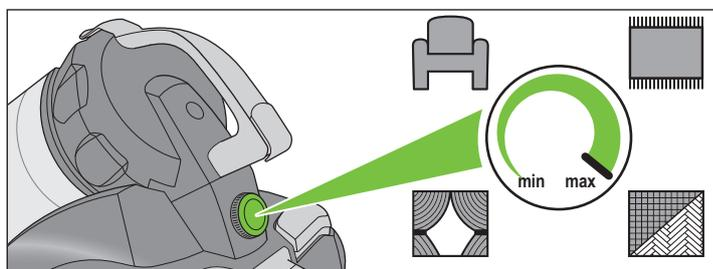
El regulador de potencia (vea arriba) puede regularse de forma gradual. La posición del regulador de potencia debe adaptarse a la superficie aspirada:
