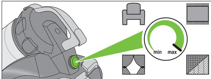
De vermogensregelaar (zie boven) is traploos verstelbaar. Afhankelijk van de te zuigen ondergrond moet de stand van de vermogensregelaar aangepast worden:
