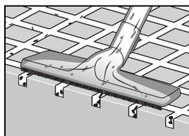
La bocchetta per pavimenti duri si adatta al meglio per pulire pavimenti duri con incisioni/fessure e giunti. Per pulire in modo ottimale incisioni/fessure e giunti, la bocchetta deve appoggiare completamente. Per aspirare il grosso dell'impurità, potrebbe essere d'aiuto inclinare leggermente la bocchetta.
