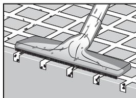
Het harde vloer-mondstuk is uitstekend geschikt voor de reiniging van harde vloeren met spleten en voegen. Om spleten en voegen optimaal te reinigen, moet het mondstuk volledig erop geplaatst worden. Om grof vuil op te nemen, kan het helpen om het mondstuk iets te kantelen.
