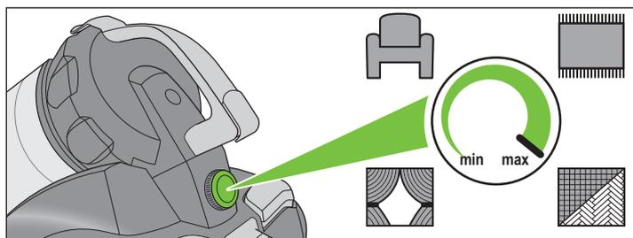
Le régulateur de puissance (cf. ci-dessus) se règle progressivement. Adapter le réglage du régulateur de puissance à la surface aspirée :
