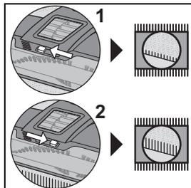
Die Turbobürste ist ideal für die Aufnahme von Tierhaaren und das Aufrichten des Teppichflors. *Aber Vorsicht: nur unempfindliche Oberflächen mit der Turbobürste reinigen. Anderenfalls kann es zu Beschädigungen kommen.* Über den Schieberegler kann die Drehzahl der rotierenden Bürstwalze angepasst werden:
