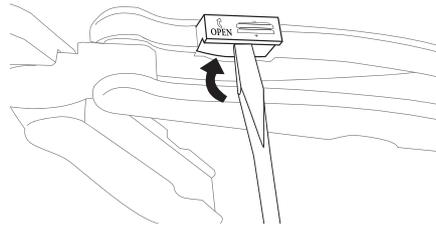
Öffnen Sie das Batteriefach (mit "Open"), stecken Sie einen kleinen Schrittschraubendreher o.ä. in die Vertiefung des Batteriefaches und ziehen dieses heraus. Entfernen Sie die Isolierfolie, zwischen den zwei CR1220 Batterien. Legen Sie beide Batterien ggf. wieder in das Batteriefach ein (bitte auf die Polarität +/- achten) und schließen Sie das Batteriefach.
