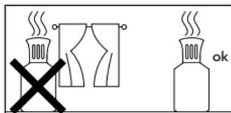
Die Lampe darf nicht in unmittelbarer Nähe von Vorhängen oder entzündlichen Materialien/ Gegenständen verwendet werden, da der Brenner beim Betrieb der Lampe sehr heiß wird.
