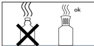
Die Lampe darf keinesfalls ohne die Schutzkrone betrieben werden. Wenn die Lampe angezündet worden ist, wird der Brenner sehr heiß, ohne dass man dies sehen kann. Die Krone der Lampe schützt Sie vor Verbrennungen. Zum Löschen der Lampe sollte die Schutzkrone im unteren Bereich angefasst werden.
